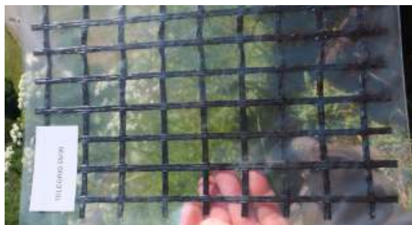
Geonett som hindrer utglidning av masser.
