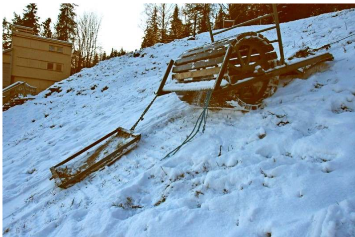
Vinsjen med restaurert elektronisk brems testet ved å trekk opp rulla.
