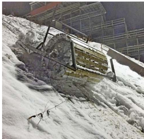
Preppeutstyr Vinsjen som trekker prepareringsrulla sveises. Prepareringsrullen testes, men var umulig å styre da styreskien var ødelagt. Den er nå fornyet. Til h.: Plastlameller skrues på for å forhindre kladding
