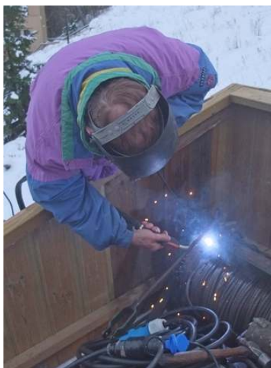
Preppeutstyr Vinsjen som trekker prepareringsrulla sveises. Prepareringsrullen testes, men var umulig å styre da styreskien var ødelagt. Den er nå fornyet. Til h.: Plastlameller skrues på for å forhindre kladding
